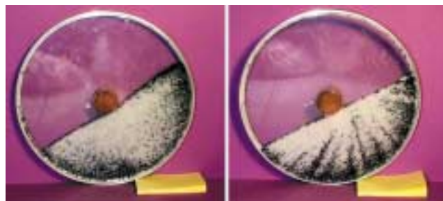
Figure 4 : Un cylindre plat (1,5 cm d'épaisseur) est à moitié rempli d'un mélange de petits grains de deux sortes différentes. Les uns (blancs) sont en verre, petits et sphériques. Les autres (noirs) sont de plus gros morceaux de verre noir pilé. Lorsque l'on fait tourner rapidement le cylindre autour de son axe (perpendiculaire au plan de la figure), les gros grains noirs se séparent des petits blancs et se réfugient sur le pourtour du cylindre. Ce n'est pas un effet inertiel, car les grains ont tous la même densité. Si au contraire, on fait tourner le cylindre lentement en laissant à chaque avalanche le temps de se produire, on observe, après quelques tours, une belle stratification en bandes blanches et noires alternées.
